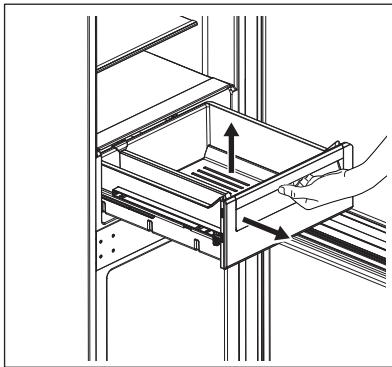
2. Гурните шине у кућиште да бисте спречили оштећивање уређаја при затварању врата.
