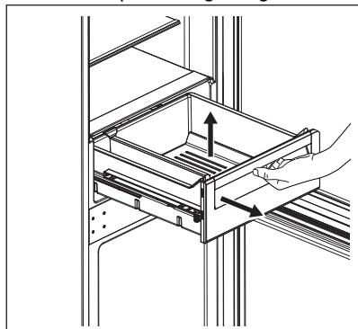
2. Potisnite vodila v napravo, da preprečite poškodbe pri zapiranju vrat.
